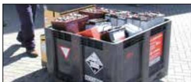
**Transporte resistente a ácidos com caixa-paleta para baterias: NSN 3990-17-101-8860. Também com tampa: NSN 3990-17-101-8861.**
