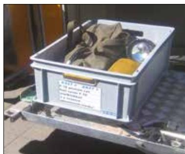
Uma embalagem especialmente concebida para os bombeiros é o contentor para garrafas de ar comprimido. As duas caixas 600x400 são soldadas e grampeadas em conjunto. Na divisão superior, são cortados orifícios do diâmetro da garrafa de oxigénio e é colocado um compartimento no fundo do contentor inferior para suportar as botijas. Graças à tampa reforçada e às dobradiças de aço, este contentor é bastante resistente e compatível com as restantes caixas da gama **E-LINE**.
