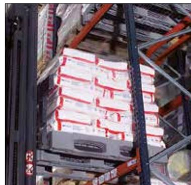
**Cargas pesadas: para cargas a partir de 500 kg para armazenagem em altura. Indeformáveis e rígidas. Resistem a elevadas temperaturas quando armazenadas em alturas.**
